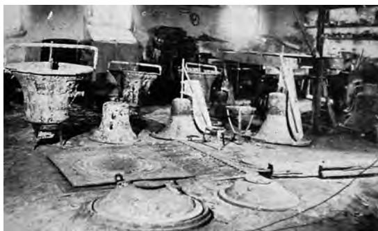
Слика 22. Амерички начин израде звона помоћу „кокила“, примењен у Ливници „Пантелић“ од 1924. године.
